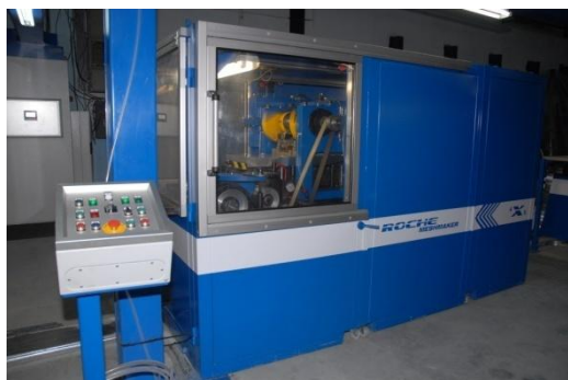
Слика 5: машина за експандирање ROCHE
