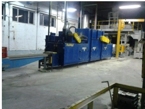
Слика 6: Машина за пастирање Flash Maid
