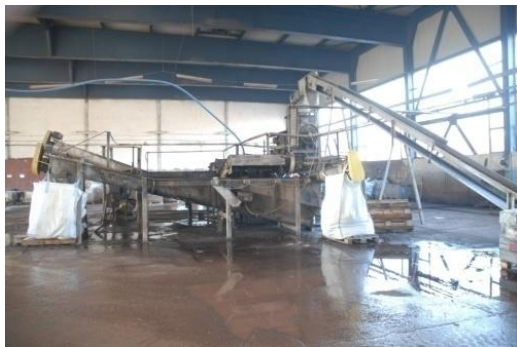
Слика 11: Дробилка за стари акумулатори
