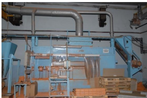
Слика 8: Машина за вибрирање TUDOR
